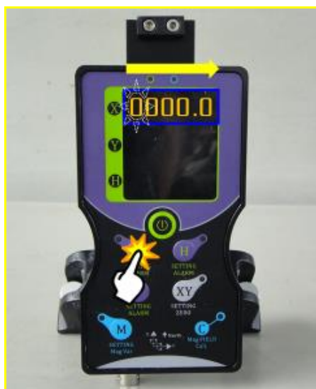
圖廿一 「數位指北儀」裝定方位基點方位角示意
