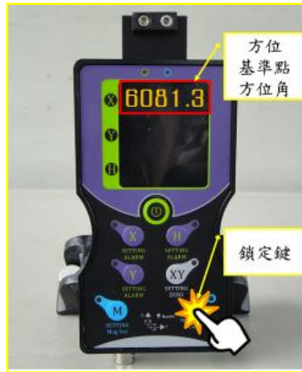
圖廿三 解除「數位指北儀」顯示幕鎖定示意
