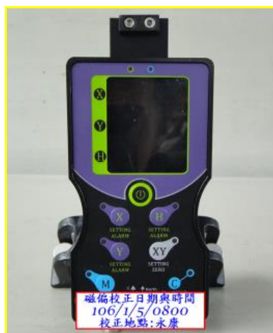
圖廿六 磁偏校正日期與時間記錄於數位指北儀本體下方示意
