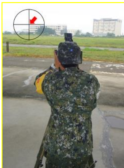
圖十八 操作蔡司測距經緯儀標定目標示意 圖十九 看讀「數位指北儀」磁/方格方位角示意
