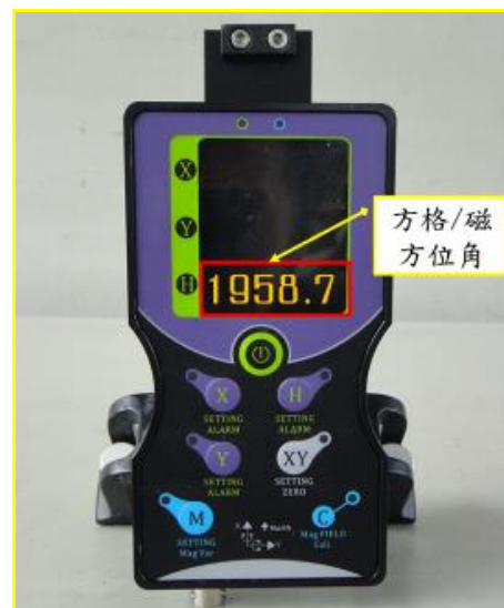
圖十八 操作蔡司測距經緯儀標定目標示意 圖十九 看讀「數位指北儀」磁/方格方位角示意
