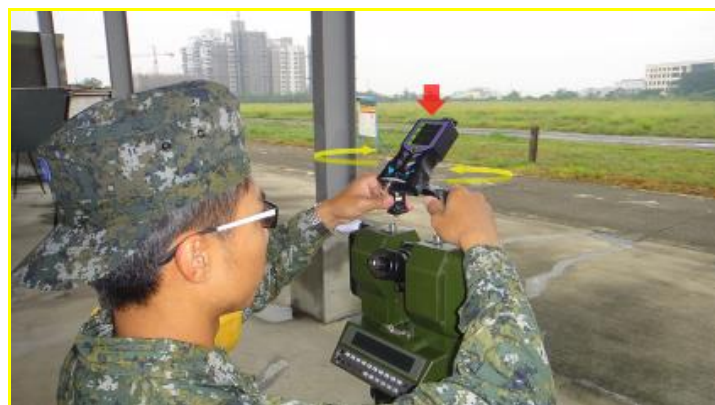
圖十五 蔡司測距經緯儀結合「數位指北儀」示意
