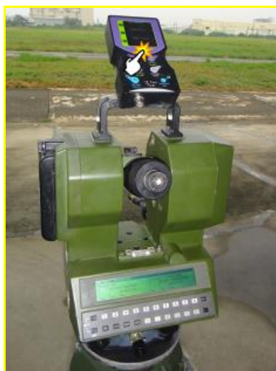
圖十八 操作蔡司測距經緯儀標定目標示意 圖十九 看讀「數位指北儀」磁/方格方位角示意
