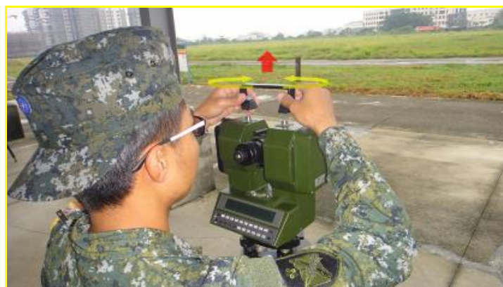
圖十五 蔡司測距經緯儀結合「數位指北儀」示意
