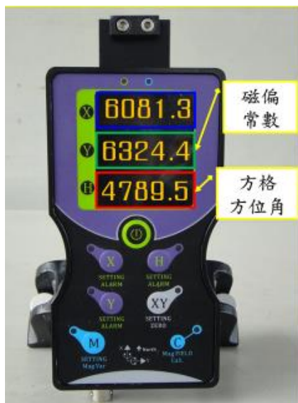
圖廿四 「數位指北儀」顯示磁偏常數與方格方位角示意
