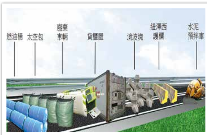
圖六 雪山隧道坑外組絕配置示意圖
