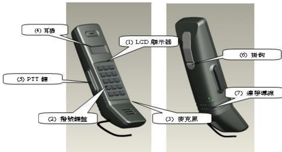
圖十一 37C無線電機與語音閘道器介接通資整合平台
