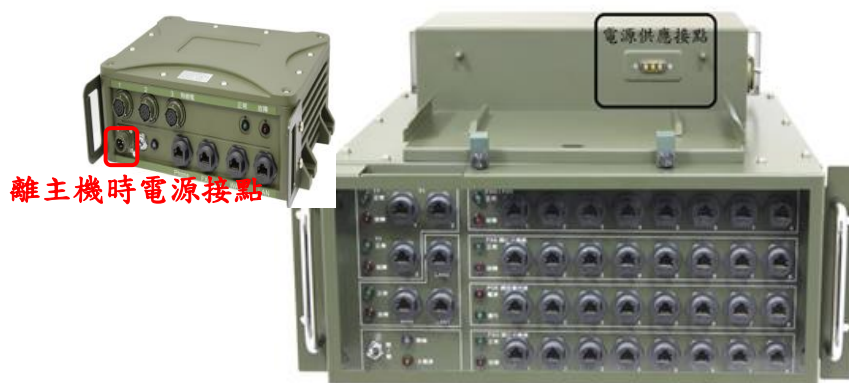
圖三 無線電語音閘道器安裝示意圖
