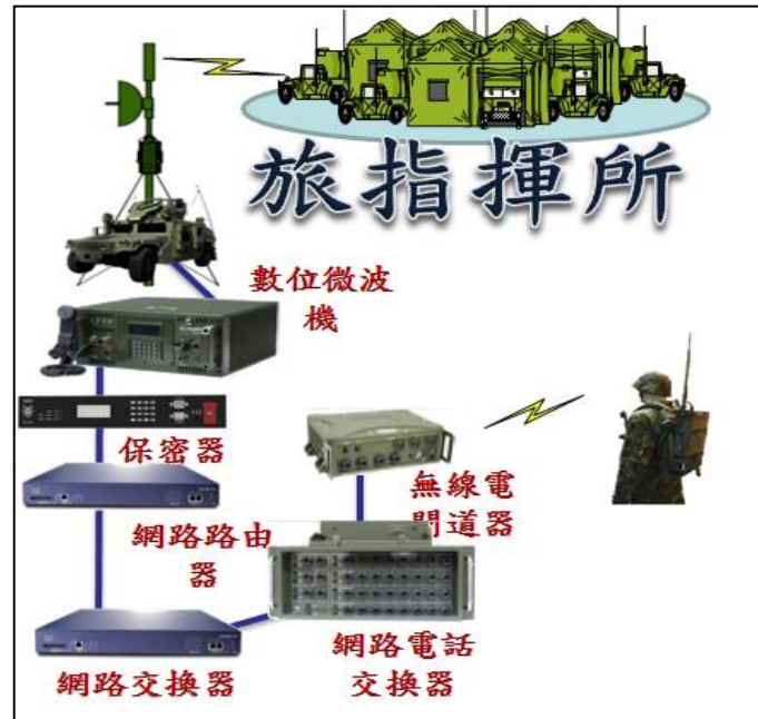
圖二 無線電語音閘道器系統架構
