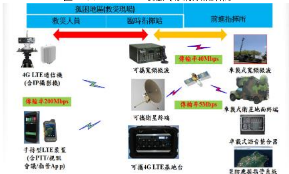
圖二十四 4G LTE 可攜式專網系統架構
