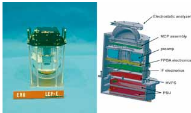
圖四 LEP-E儀器實體(左)及結構(右)圖
