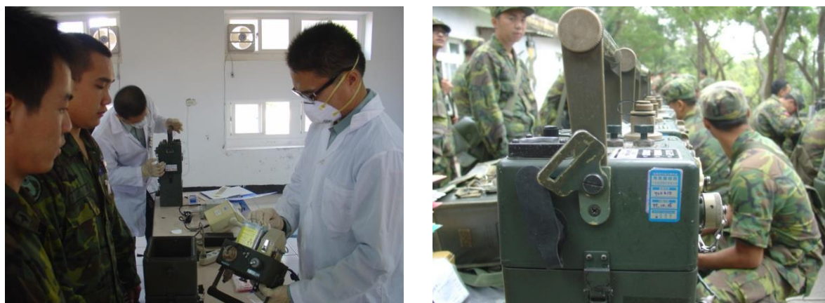
圖 5 密封放射性物質輻射安全擦拭測試
