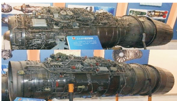
圖5：俄羅斯「流里卡·土星」廠製AL-31F與中共自製「渦扇-10」（太行）超音速發動機外型比較。
