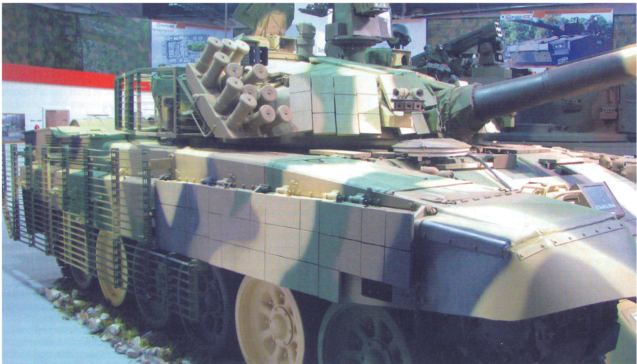
波蘭PT-72U主戰車在砲塔和底盤之間加裝柵格式保護裝甲，具有八套全天候攝相組，以及由塔爾努夫機械廠生產的ZSMU-1276A3「燕隼」遙控機槍塔。(Source: Robert Czulda)
