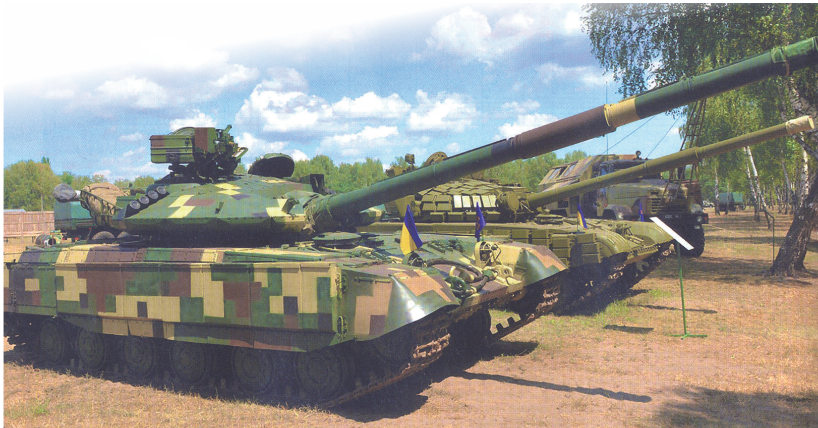
烏克蘭莫羅佐夫設計局的T-64BM布拉鋼主戰車，重量45噸，外掛T-72用的主動防護裝甲。(Source: Ukroboronprom)
