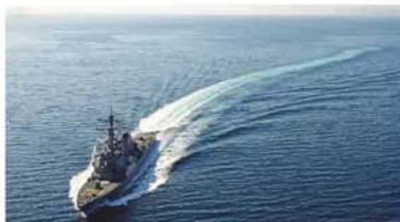
圖9 水面艦表面波尾流的中央湍流區和兩側的「V」字型的波峰線。資料來源： http://blogs.militarytimes.com/scoopdeck/2010/02/25/next-big-surface-ship-flight-iii-ddg/
