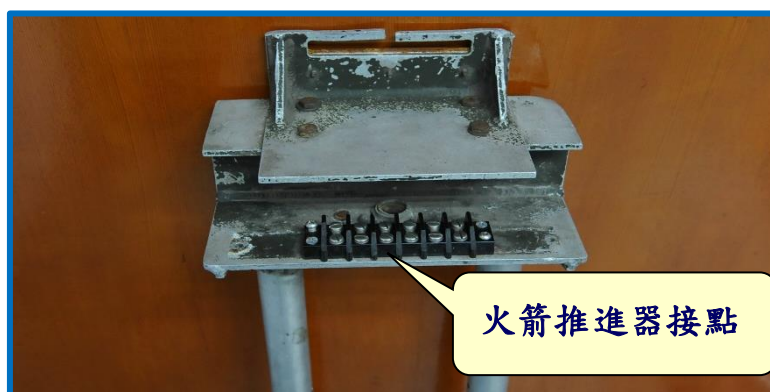
圖五 BATS 靶彈發射接線板示意圖
