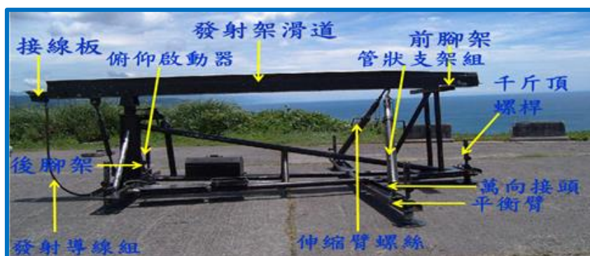
圖三 BATS 靶彈發射架構造示意圖
