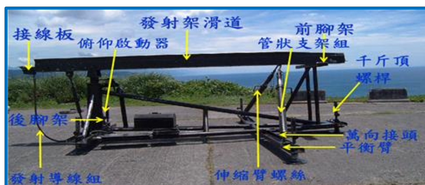
圖三 BATS 靶彈發射架構造示意圖
