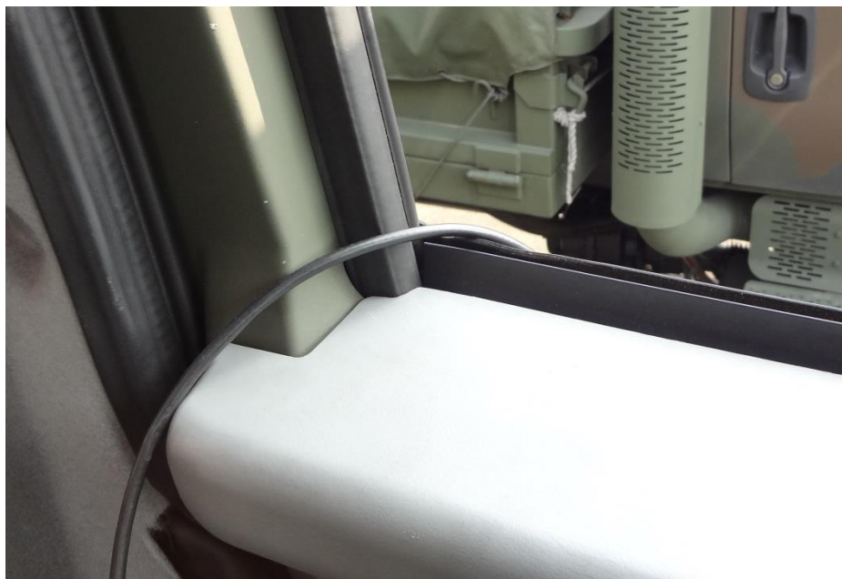
圖二 BOW1射頻導線藉車窗延伸至車外
