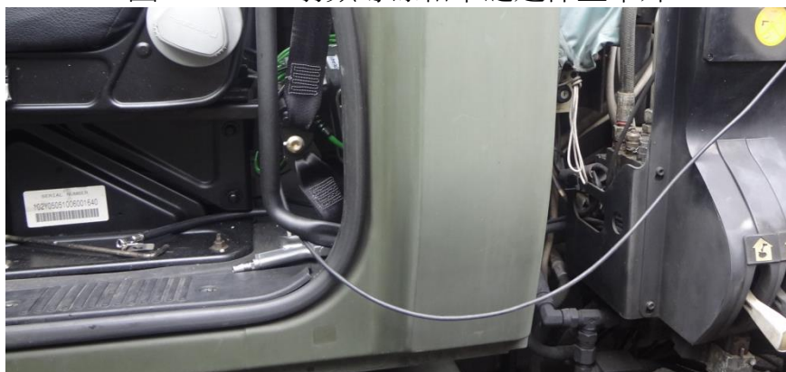
圖三 BOW1射頻導線藉車縫延伸至車外
