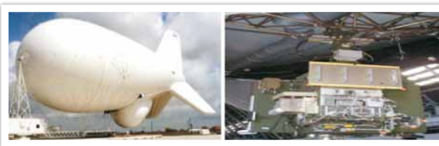
圖一 左圖為美軍陸軍聯戰攻陸飛彈防禦空浮雷達系統氣球本體；右圖為氣球內之哨兵雷達。
