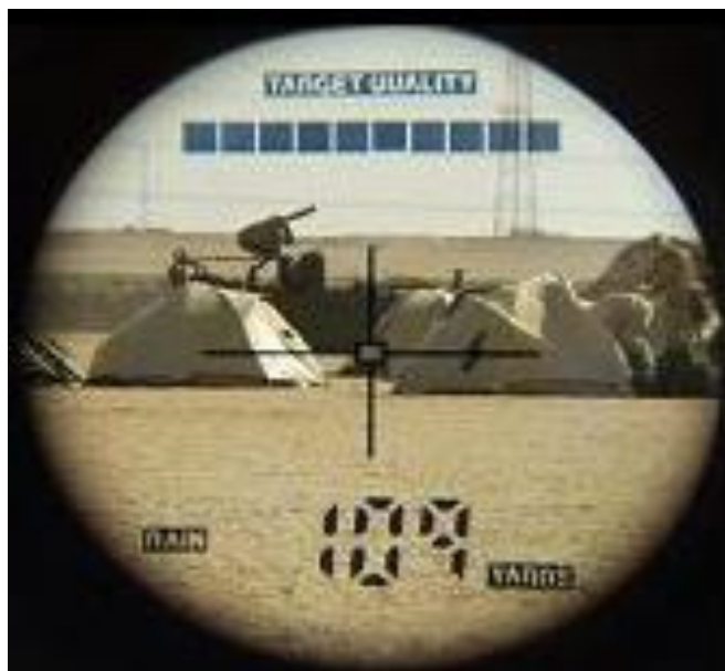
圖十一：AN/GVS 雷射測距儀測距示意圖
