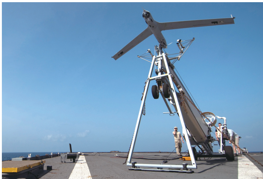
掃描鷹無人機具長續航力特性，運用氣動彈射發射架起飛，毋須跑道。
