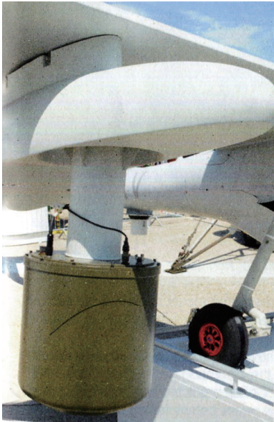
薩基姆電子防衛公司(Sagem)於2013年6月間，對其「巡航者」(PATROLLER)無人飛機系統進行一系列飛行測試；其機翼下方為通信情報艙裝配多重感測器之構型。
