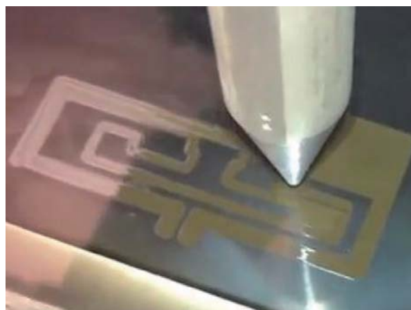
圖十 利用3D列印技術在塑膠基板上印製天線
