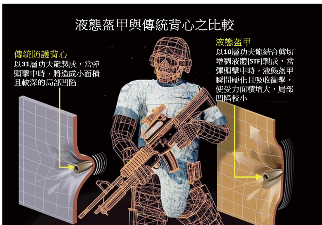
圖七 液態盔甲（Liquid Armor）與傳統背心之比較
