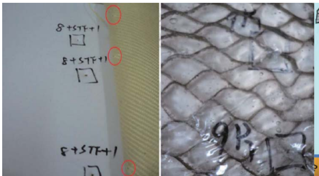
圖十八 以蜂巢結構產製液態盔甲
