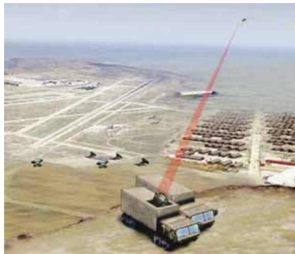
圖十三 激光武器的缺點是不能全天候作戰，受限於大霧、大雪、大雨，而且激光發射系統屬精密光學系統，在戰場上的生存能力有待考驗。
