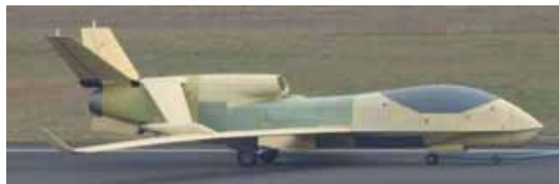
圖廿一 新型大型無人機與牽引車輛有直觀的大小比較，能非常清楚地看到機翼與尾翼結合為一體，形成聯接翼結構。
