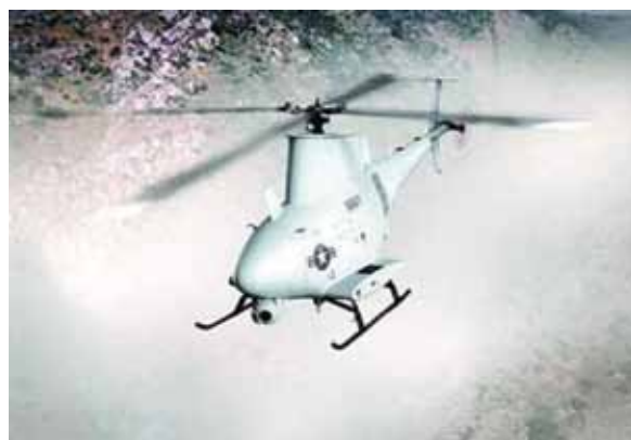
圖十六 MQ-8B“火力偵察兵”無人直升機MQ-8B的續航時間也增加到8小時以上在飛行試驗中，MQ-8B完全自主地完成了使命。這種新型無人駕駛飛行器不但可探測目標，而且還可利用機載武器對其實施攻擊。MQ-8B配備的武器系統包括非制導火箭彈、機槍和多種型號的導彈。其最大戰鬥負荷可達260公斤。MQ-8B可用於執行偵察、目標指示、通訊和對點目標進行攻擊。該機將配屬旅級作戰部隊。
