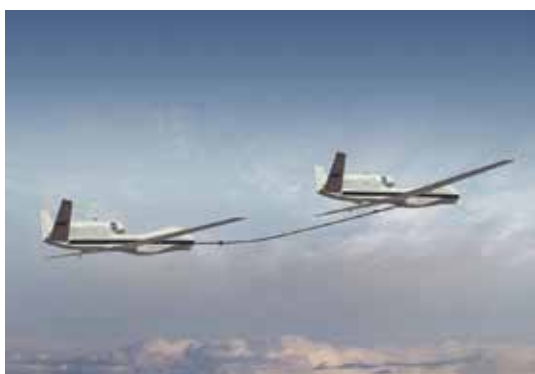
圖十五 兩架改進型的全球鷹無人機正在進行空中加油測試。
