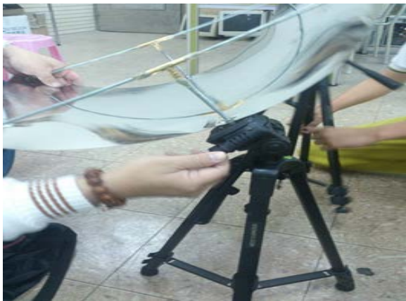
圖 9 設定太陽能雙效滅菌系統的方向與角度
