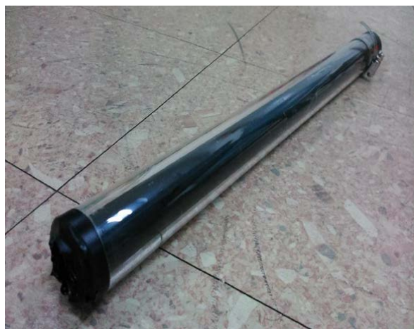
圖 8 導熱管覆蓋上一層黑色吸收膜
