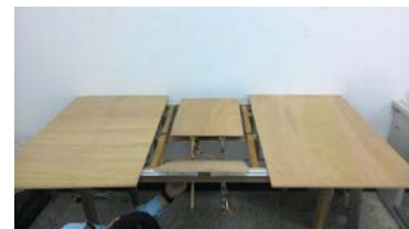
步驟 3：當左右桌面觸及極限開關後，左右桌面停止移動，中間伸縮桌開始下降，計時器開始計時。
