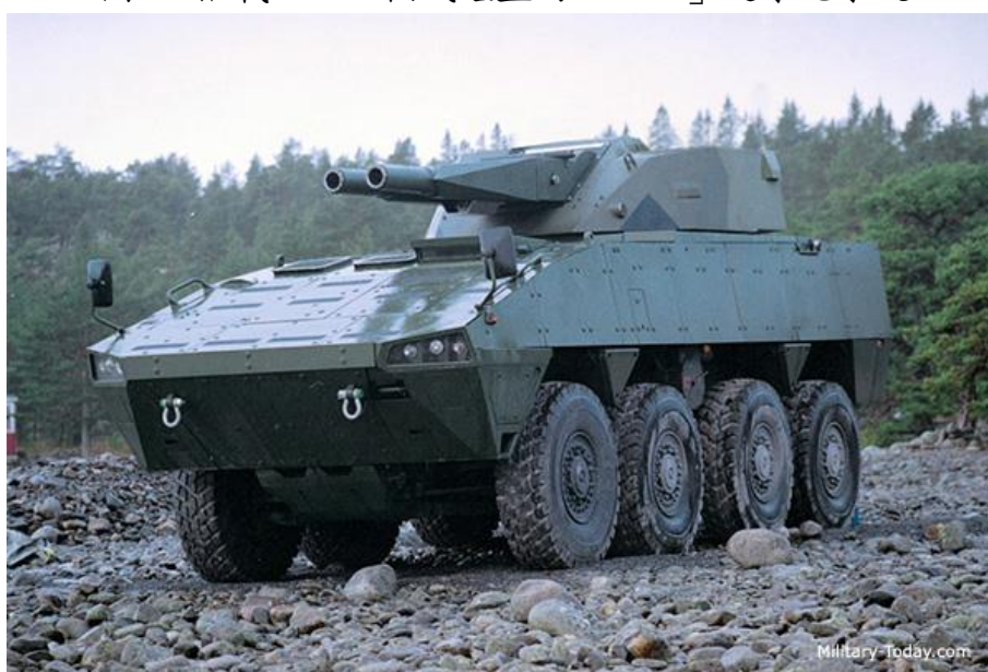
圖三 搭載於 AMV 輪式底盤的「AMOS」迫擊砲系統
