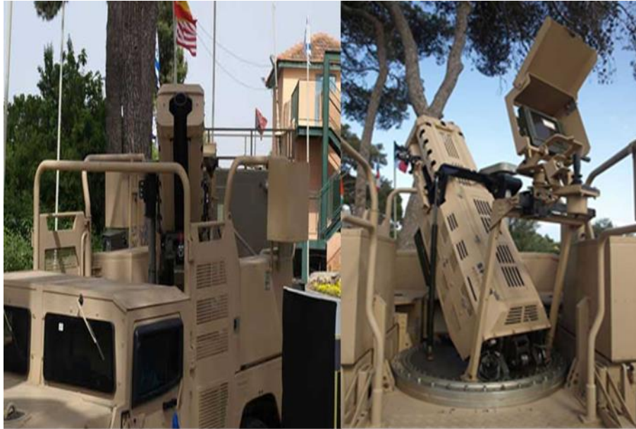
圖八 以色列「SPEAR」迫擊砲射擊指揮系統
