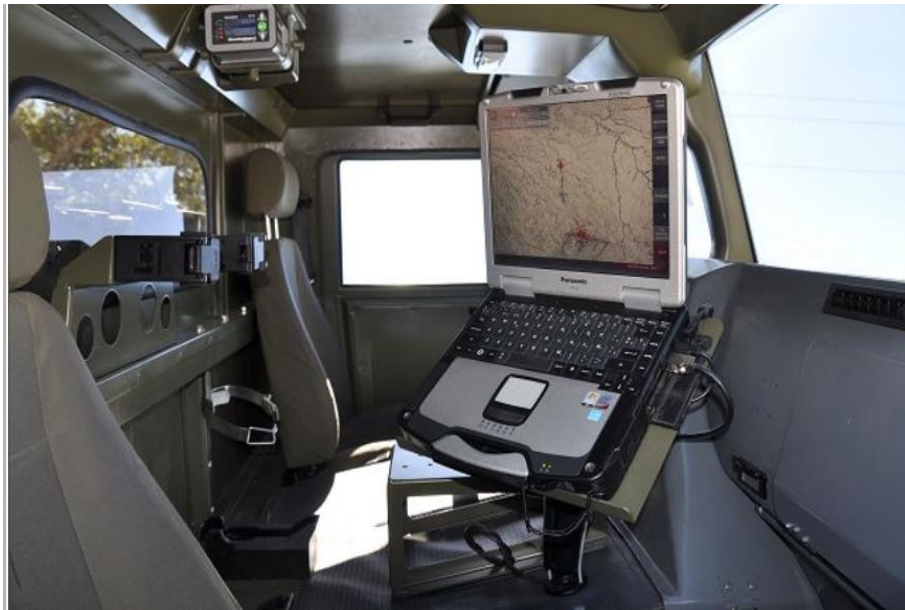
圖七 西班牙 60、81 公厘綜合迫擊砲射擊指揮系統
