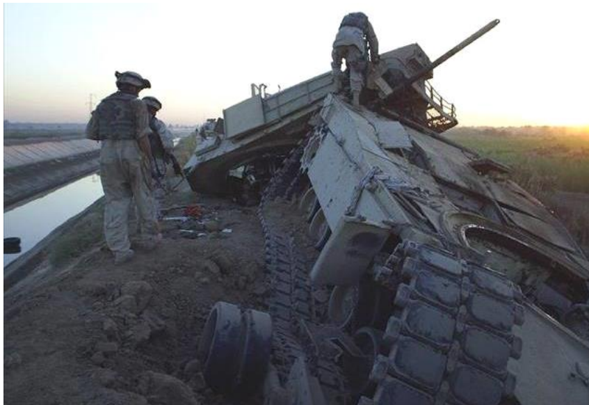
圖三：遭一枚 550 公斤炸彈製作之應急爆炸裝置（IED）所摧毀的 M1 艾布蘭主戰車
