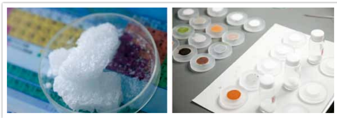
圖五 中孔二氧化矽(左)吸附材料的顏色隨吸附物質不同而變化(右)
