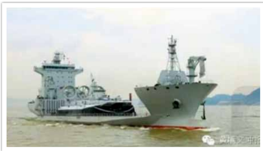
圖八 東海島號搭載野牛級氣墊艇
