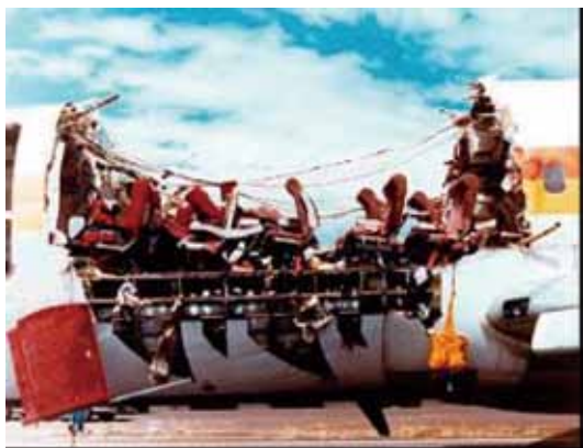
圖九 1988年美國阿羅哈航空公司一架波音737-200型客機前機身撕裂脫落。圖片來源：參考文獻11
