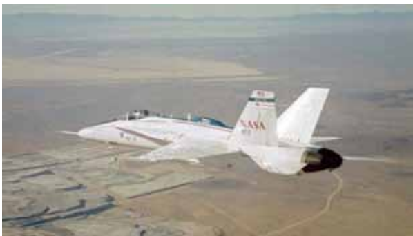
圖四 美國航太總署F-18主動式氣彈機翼飛行試驗機，機翼上滿布試飛儀電來記錄氣彈特性。 圖片來源：參考文獻13
