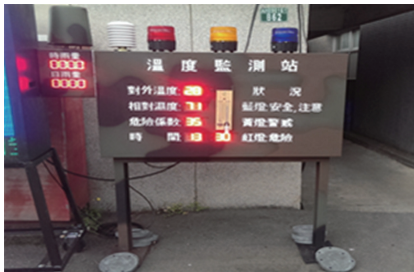
圖9 本院環資系大氣組與中科院合作開發之第一代「多元環境監測平臺」，可即時感測雨量、氣溫、濕度等大氣參數，並將大氣參數換算為「危險係數」，藉由紅、黃、藍等不同燈號，實施警示。（畫面中的數據僅為儀器測試數據，並非實際換算危險係數的結果）
