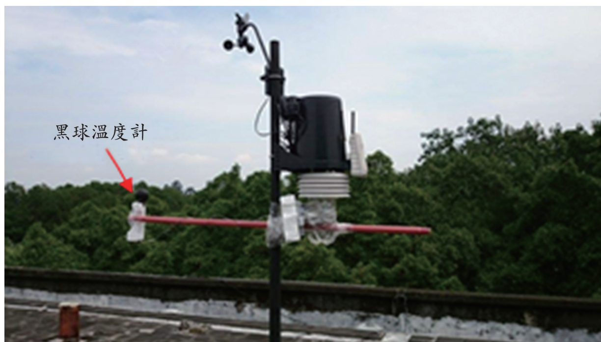
圖3 Davis 6152全自動氣象觀測儀及自製黑球溫度計（置於紅色木桿前端，紅色箭頭處）整合影像
