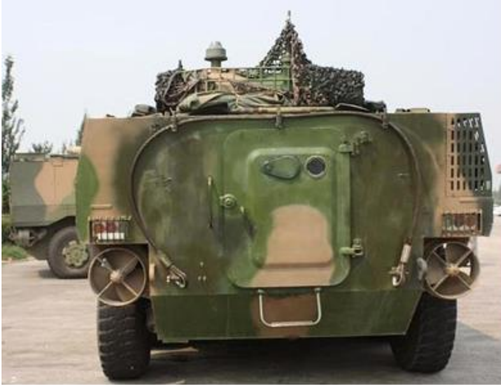
圖八：ZBL-09 型輪式步戰車浮游推進器
