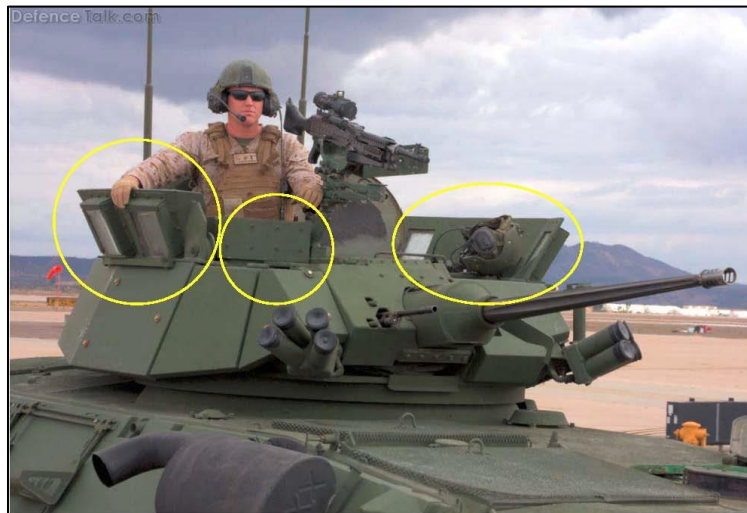
圖十四 美國海軍陸戰隊的 LAV-25 甲車於砲塔四周加裝有觀景窗的防彈護盾 (黃圈內所示)
