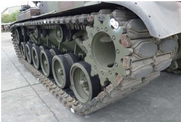
圖二 M60A3戰車履帶(圖左) 11 及戰車履帶膠塊(圖右) 12
