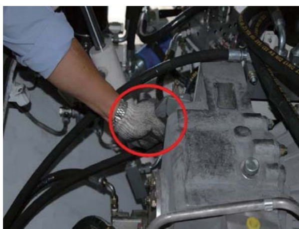
圖十二 加力箱動力解脫作業
