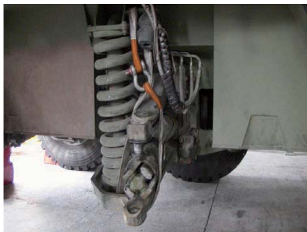
圖二十 CM32系列八輪甲車輪區總成應急性的搶修作業
