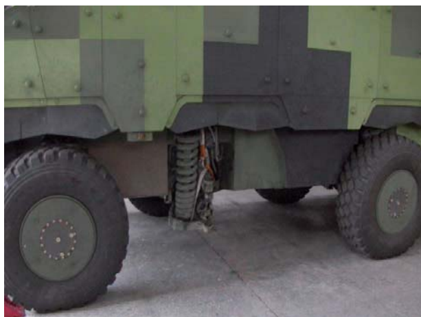
圖二十 CM32系列八輪甲車輪區總成應急性的搶修作業
