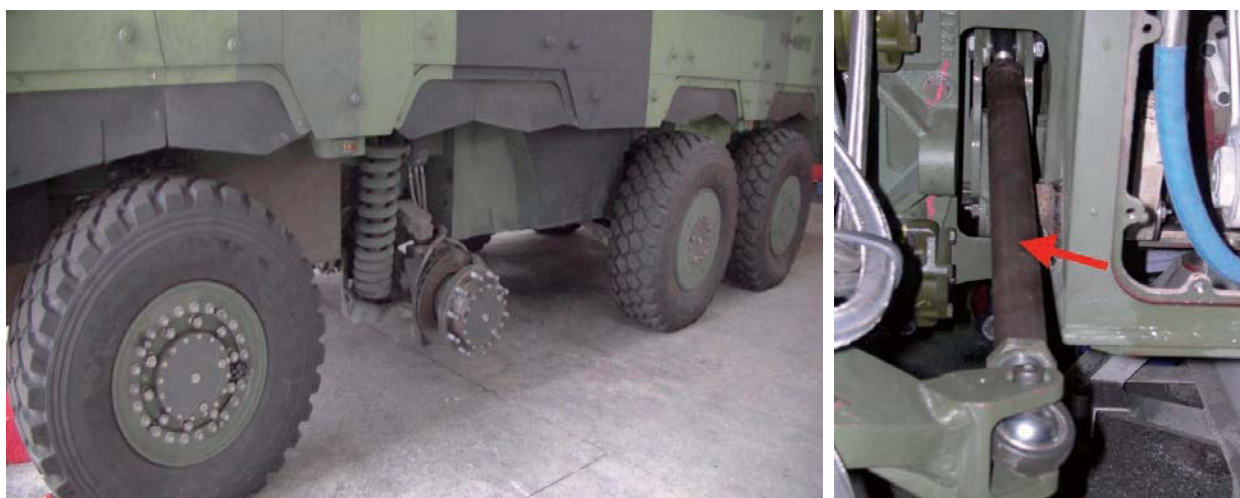
圖十八 CM32系列八輪甲車轉向系統應急性的搶修作業
