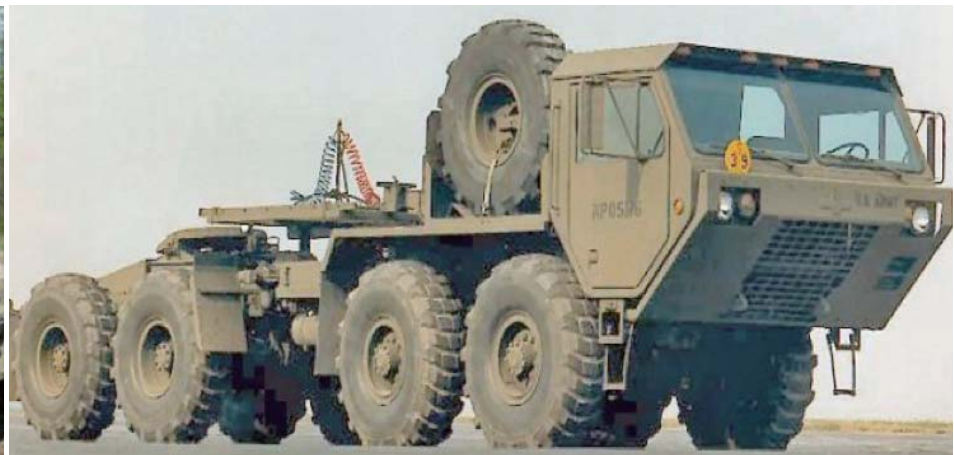
圖八 M983牽引車 (附絞盤，無起重機)
