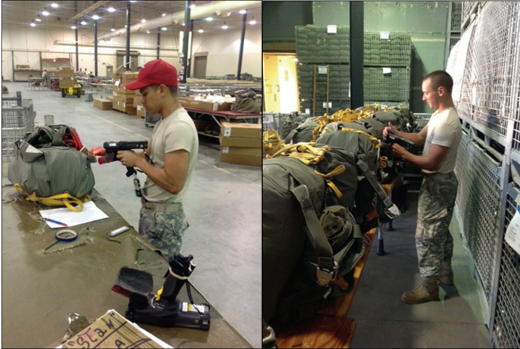
圖六 美軍使用讀取器讀取降落傘 RFID 標籤
