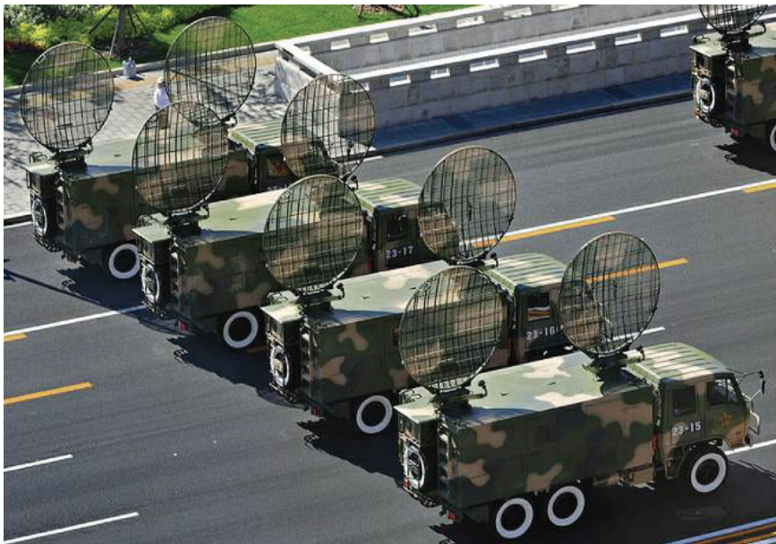
圖九 中國大陸TS-504對流層散射通信系統
