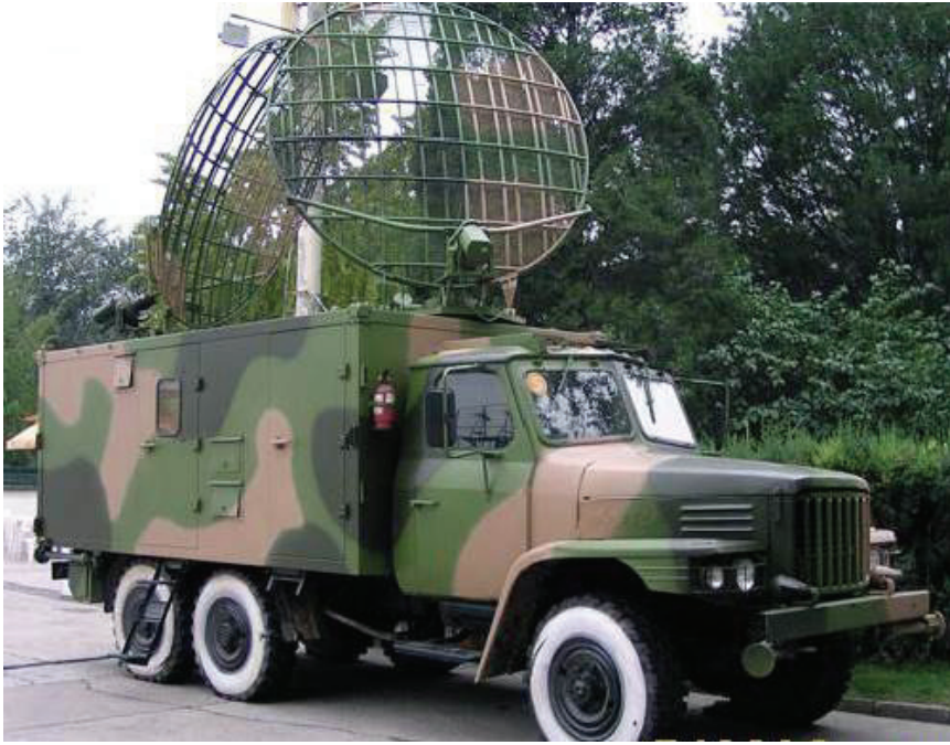
圖八 中國大陸TS-510對流層散射通信系統
