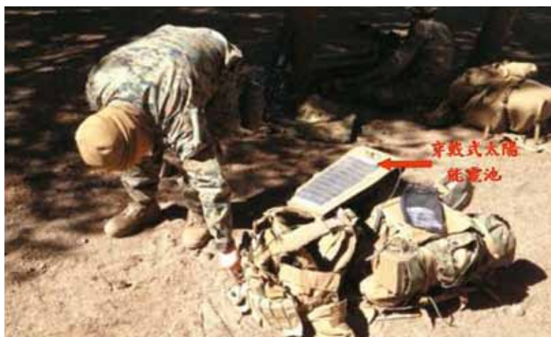
圖五 美國海軍陸戰隊在加州軍事訓練場地測試穿戴式太陽能電池
