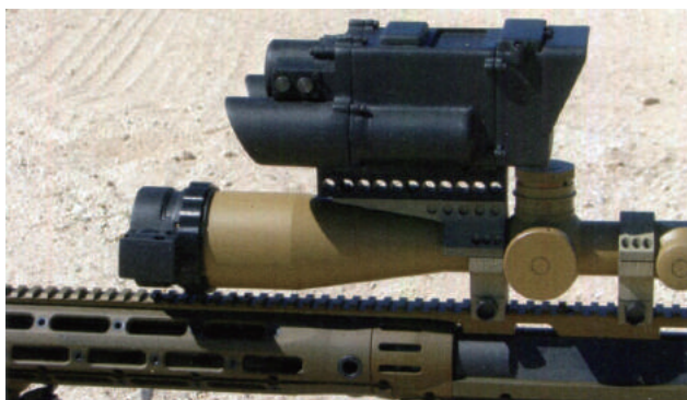
美國國防先進研究計畫局「一發命中次世代」計畫中的狙擊瞄準具可自動測量與修正風偏、高差、方向和速度。(Source: DARPA)
