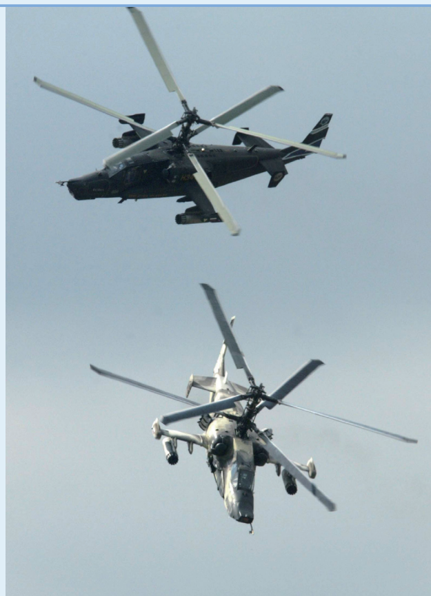
卡-52短吻鱷(下)是卡-50黑鯊(上)武裝直升機的改良型，其具有全天候作戰能力，採用共軸雙旋翼設計，可提升機動性和穩定性。(Source: REUTERS/鐘志)
