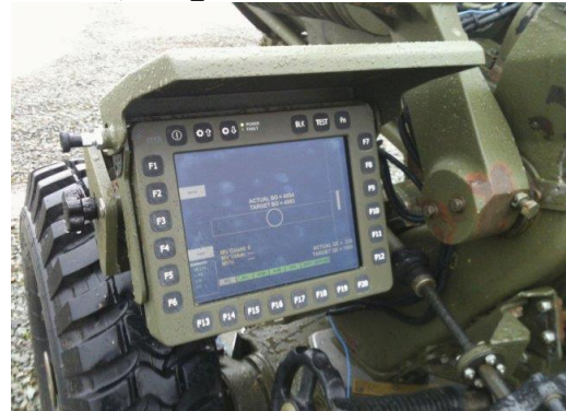
圖九 安裝於英軍 L118 式 105 公厘輕榴砲左砲耳之新型「瞄準手顯示與控制單元」(LDCU)
