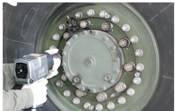
拆卸鋼圈固定螺釘
