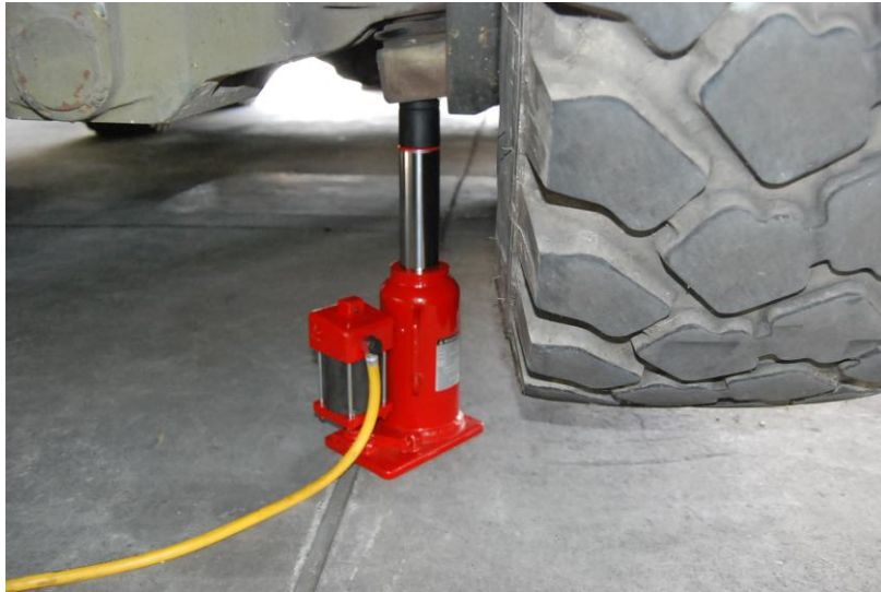
圖十 氣壓式千斤頂頂高作業
