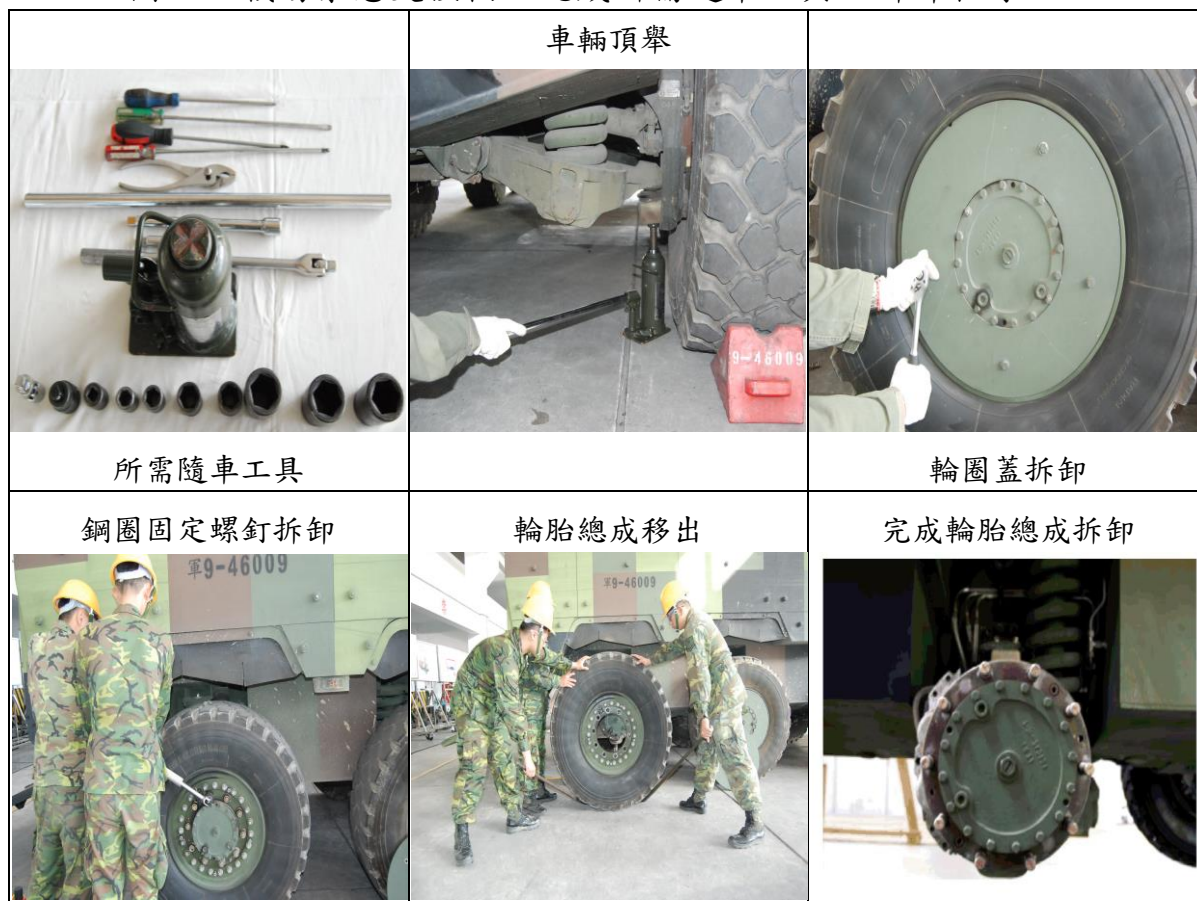
圖三 戰場緊急更換輪胎總成所需隨車工具及拆卸程序
