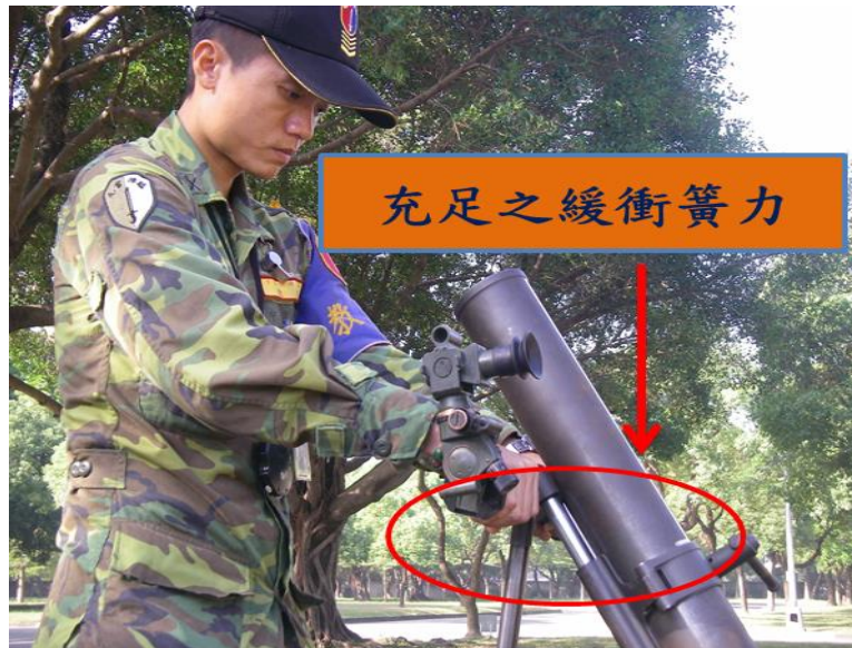
圖十五 檢查緩衝機簧力
