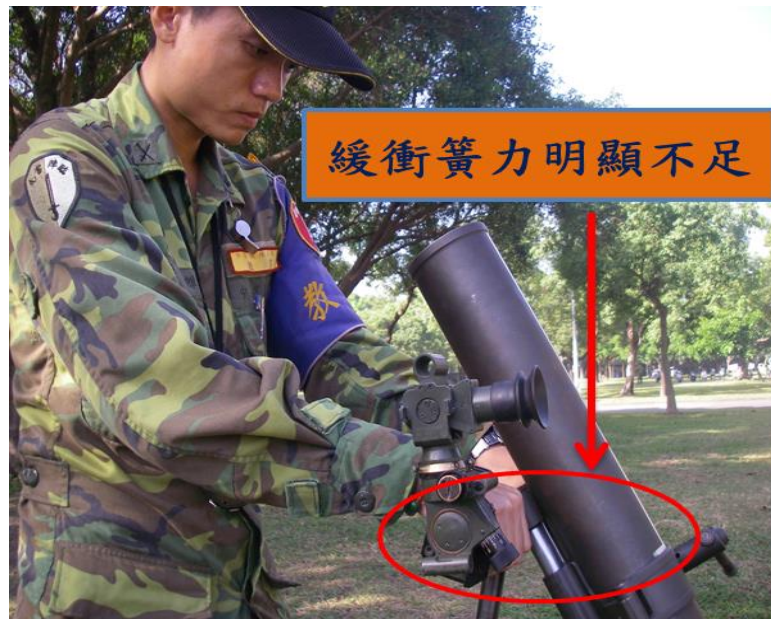
圖八 檢查緩衝機簧力
