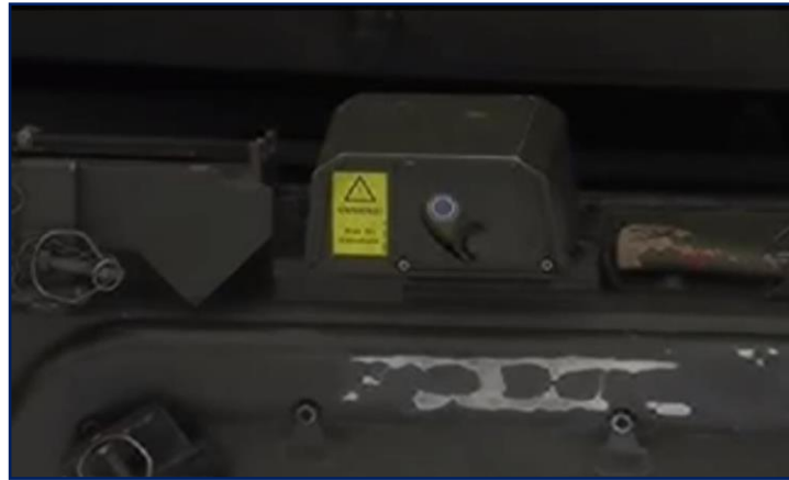
圖五 安裝於砲塔外部鎖孔式攝影機
