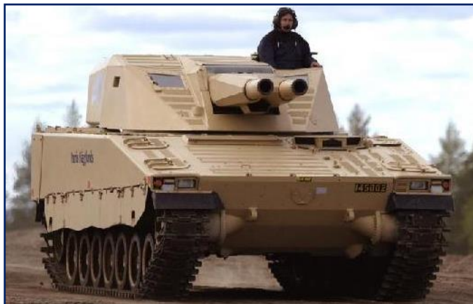
圖七 安裝於 CV90 履帶式裝甲車底盤上
