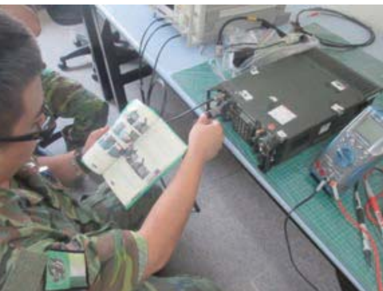
圖一 檢驗士使用2945B儀表檢測37無線電機音準值及頻率是否符合標準
