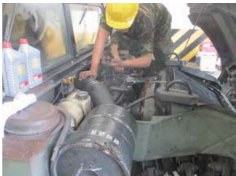
圖二 檢驗士檢查悍馬車預熱塞控制器
