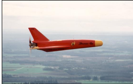
圖四 BANSHEE 遙控靶機外觀圖
