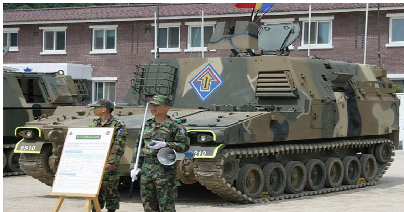
圖五 K77 射擊射擊指揮車
