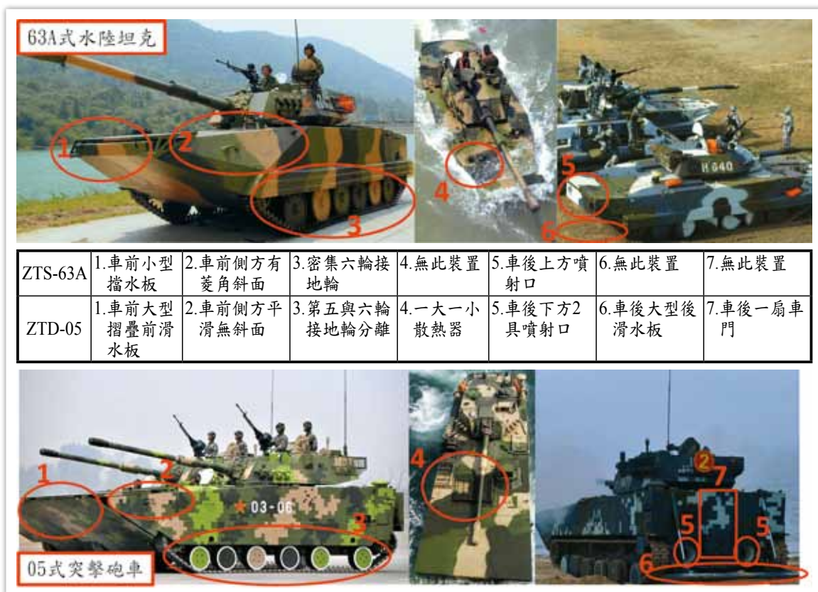
圖一 共軍ZTS-63A式與ZTD-05式外型差異比較圖
