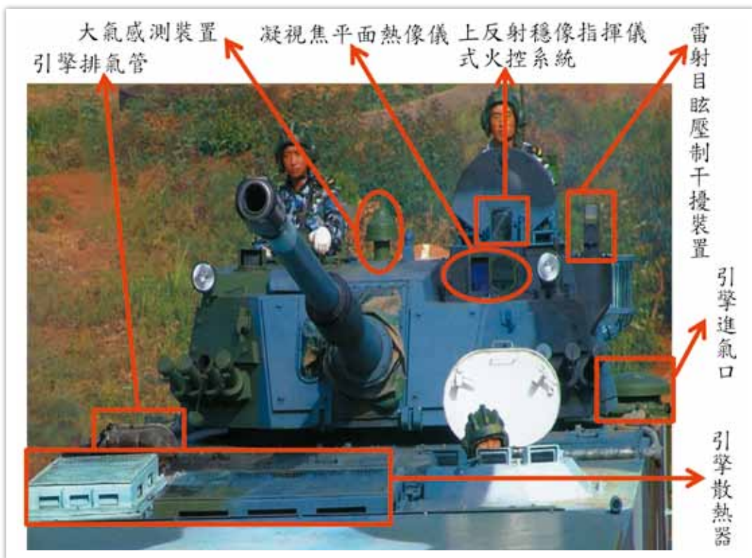
圖六 ZTD-05式突擊砲車外部裝置位置實況圖
