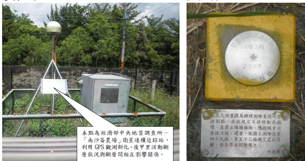
圖一 GS35「南沙崙農場」一等衛星控制點 圖二 R299「南一高球場」三等衛星控制點 (GPS 連續站)
