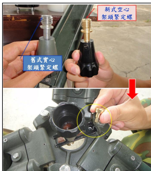
圖九 更換架頭緊定螺
