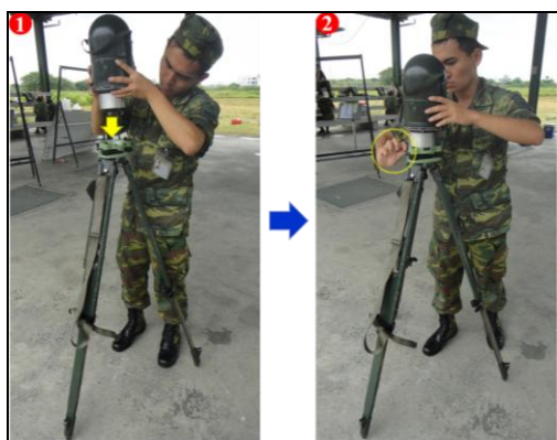
圖十五 整置 M2 方向盤本體
