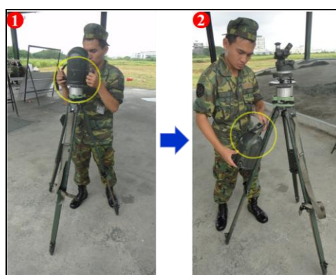
圖十六 取下 M2 方向盤攜行罩
