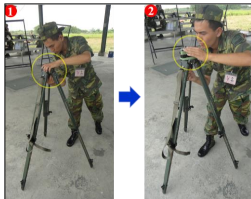
圖十四 調整腳架高度居中水準氣泡
