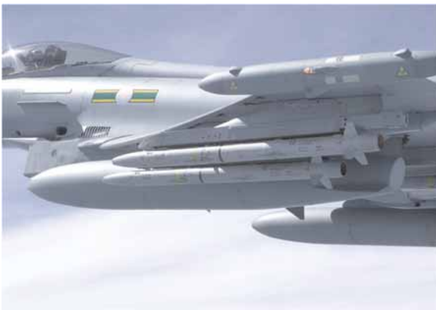
〈圖4〉由英國皇家空軍「颱風號」多功能戰鬥機左翼下搭載的2枚AIM-132 ASRAAM「先進短程空對空飛彈」於2007年進行飛測科目。
