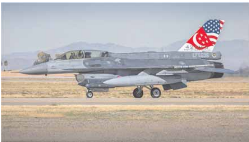
〈圖10〉新加坡空軍第425中隊的F-16D Block 52+戰鬥轟炸機，任務構型已接近於F-16 Block 60。
