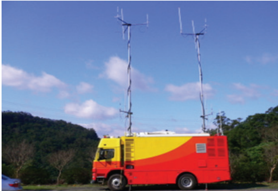
圖十一 現場通信指揮車暨整合平台外觀圖
