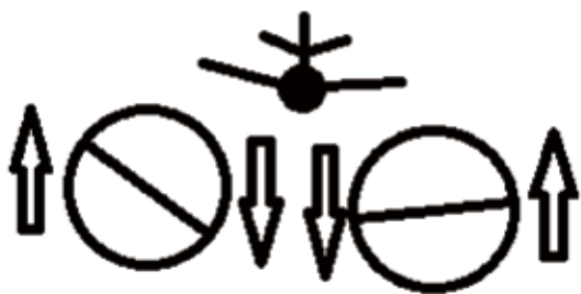
圖一 機尾亂流肇生型態示意圖；當飛機起飛或降落階段，機翼因為上下壓力差而產生升力，當機翼下方的高壓氣流流向機翼上方低壓區時，會在機翼翼端產生捲狀的渦流。其中，左翼為順時針捲狀渦流，右翼為逆時針捲狀渦流。
