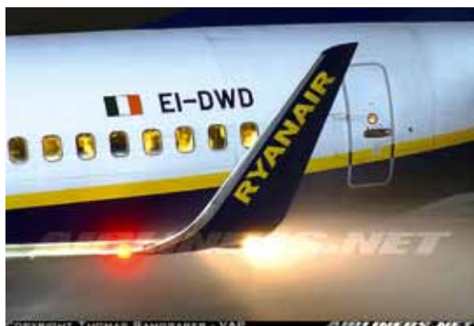
圖十 國外飛機設計廠商會在機翼尾端加上小翼(Winglet)，透過外型的流力設計，來減少受限渦流的影響與干擾
