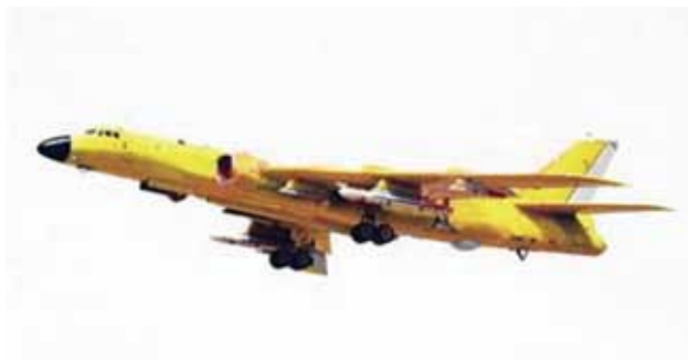
圖四 轟-6K的作戰半徑超過3,500公里，左、右機翼下各設置3個掛彈架，可各掛載3枚長劍-10(CJ-10)遠程攻陸巡航飛彈(射程1500-2,500公里)，打擊能力覆蓋第二島鏈的關島美軍基地(取材自網路)。
