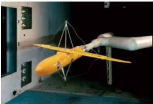
瓊斯博士在艾瑪仕研究中心穿音速風洞進行氣彈風洞吹試的斜掠翼模型機。。(圖片來源：參考文獻10)
