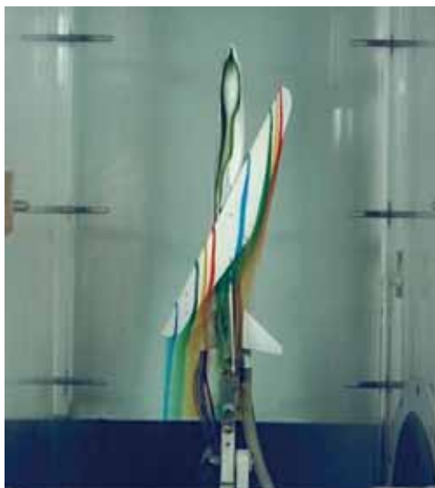
航太總署達頓中心於一九八四年在水洞內進行F-8斜掠翼研究飛機模型吹試。(圖片來源：參考文獻3)
