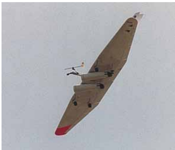
飛試中的莫理士第二架無線電遙控斜掠飛行翼模型機。(圖片來源：參考文獻7)
