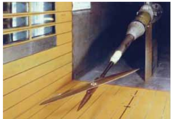
艾瑪仕研究中心穿音速風洞內，吹試大展弦比斜掠橢圓機翼。(圖片來源：參考文獻10)
