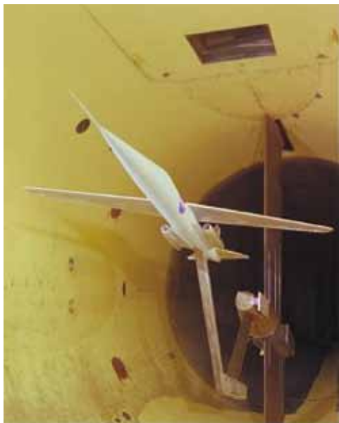
AD-1六分之一比例模型於艾瑪仕壓力風洞內吹試。
