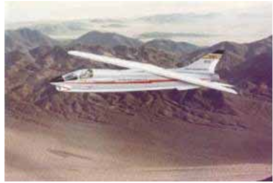
美國航太總署構想的F-8斜掠翼研究飛機。
