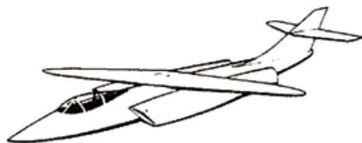
艾瑪仕研究中心為先進戰術戰鬥機專案研究的斜掠翼構型。(圖片來源：參考文獻10)
